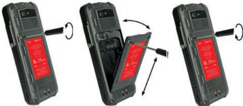
» Löysennä akkukotelon ruuvit toimitukseen sisältyväällä Torx-ruuvitallalla.
