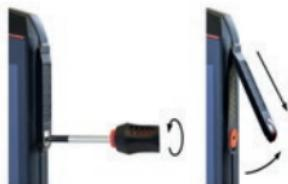
» Otpustite vijak na poklopцу 16-pin ISM sučelja isporučenim odvijačem, a koji je uključen u paket pribora. Uklonite poklopac kako je prikazano.
