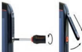
» 承認されたアクセサリパッケージに入っているドライバーで、16-pin ISMインターフェースカバーのネジを緩めます。図のようにカバーを取り外します。
