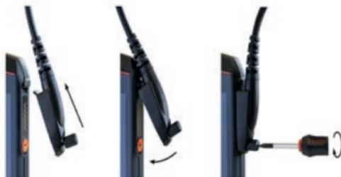
» Liitä hyväksytyn lisälaitteen liitin laitteen 16-pin ISM-liitintään kuvan mukaisesti.
