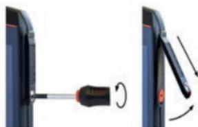
» Lösen Sie die Schraube an der 16-pin ISM-Schnittstellenabdeckung mit dem Schraubendrehер, der im Lieferumfang des Zubehörs enthalten ist und entfernen Sie die Abdeckung wie abgebildet.
