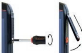
» Lossa skruven från 16-pin ISM-gränssnittets kåpa med skruvmejseln som medföljer i det godkända tillbehörspaketet. Ta bort kåpan enligt bilden.
