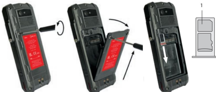
» 付属のTorxドライバーで、バッテリーのネジを緩めます。
