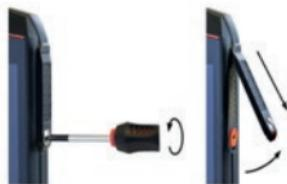
» Löysennä 16-pin ISM-liitännän suojuksen ruuvit hyväksyttyyn tarvikepakettiin sisältyväällä ruuvitalalla. Poista suojuksen kuvan mukaisesti.
