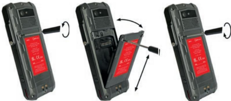
» Lossa skruvarna på batteriet med den medföljande torxmejseln.
