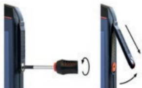
» Løse skruen i dekselet for 16-pin ISM-grensesnittet med skrutrekkeren som fulgte med det godkjente tilbehøret. Fjern dekselet som vist.
