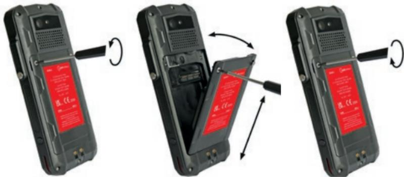
» Løsne skruene på batteriet med den medfølgende Torx-skrutrekkeren.
