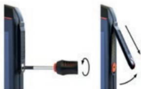
» Za pomocą wkrętaka z zestawu zatwierdzonego przez firmę i.safe odkręć wkręt pokrywy interfejsu 16-pin ISM. Zdejmij pokrywę w przedstawiony sposób.
