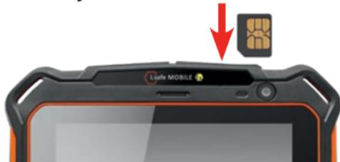
» Otvorte IP-plug na slot pre SIM kartu.
