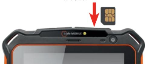
» 打开SIM卡插槽上的IP PLUG。
