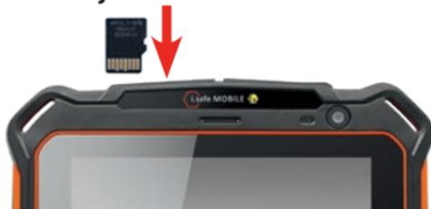
» Otvorite IP utikač na otvoru za SD kartičku.
