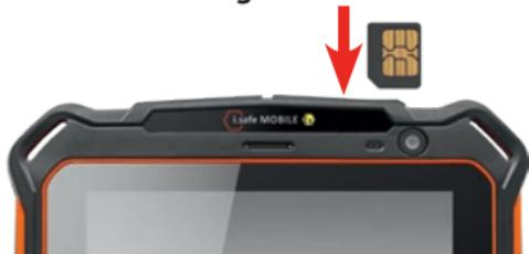
» Open de IP-plug van de SIM-sleuf.
