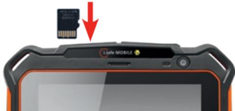
» Otevřete IP-plug slotu pro SD kartu.
