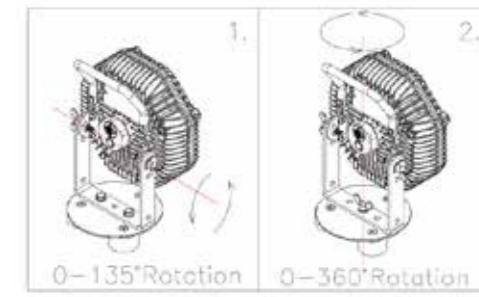
**Instalación del soporte:** Fije el soporte a la lámpara. Utilizar hexágono interno M6 Atornille el soporte a la lámpara como se muestra en el diagrama a continuación.
