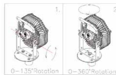
**Installation du support:** Fixez le support à la lampe. Utiliser l'hexagone interne M6 Visser le support sur la lampe comme indiqué dans le diagramme ci-dessous.
