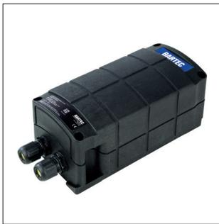
Das Versorgungsmodul Ex i dient der eigensicheren Versorgung (Barriere) des kabelgebundenen Handscanner BCS3608<sup>ex</sup>-IS und enthält eine Trennstufe (Auswertebarrriere) für die Datenleitungen im Ex-Bereich. Die Datenleitungen können ohne zusätzliche Barriere/Trennstufe im Ex-Bereich an Systeme, z.B. HMI, SPS oder Micro Prozessoren mit entsprechender Ex i-Schnittstelle angeschlossen werden.
