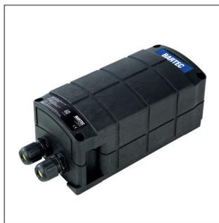
Das Versorgungsmodul Ex i dient der eigensicheren Versorgung (Barriere) des Bluetooth Handscanner BCS3678<sup>ex</sup>-IS und enthält eine Trennstufe (Auswertebatterie) für die Datenleitungen im Ex-Bereich. Die Datenleitungen können ohne zusätzliche Barriere/Trennstufe im Ex-Bereich an Systeme, z.B. HMI, SPS oder Micro Prozessoren mit entsprechender Ex i-Schnittstelle angeschlossen werden.
