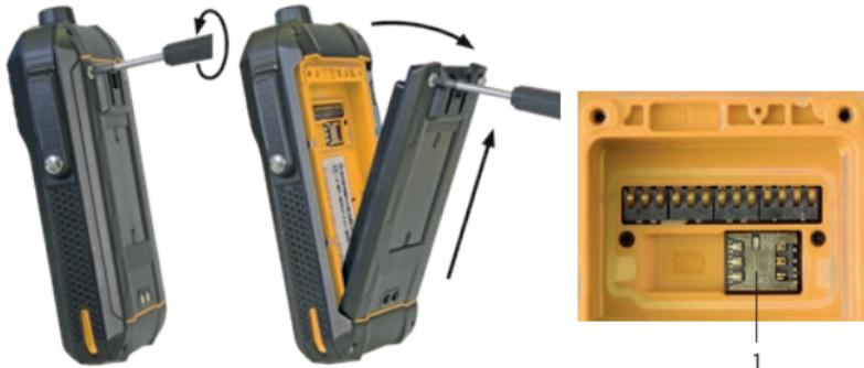
» 使用随附的梅花螺丝刀拧松电池上的螺钉。
