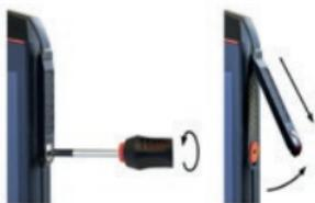
» Otpustite vijak na poklopцу 8-pin ISM sučelja isporučenim odvijačem, a koji je uključen u paket pribora. Uklonite poklopac kako je prikazano.
