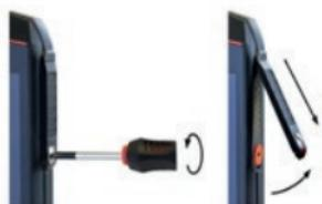
» Ослабьте винт на крышке интерфейса 8-pin ISM с помощью входящей в комплект отвертки. Снимите крышку, как показано на рисунке.
