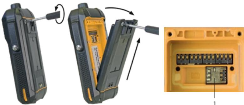
» Löysennä akkukotelon ruuvit toimitukseen sisältyväällä Torx-ruuvivaltalla.
