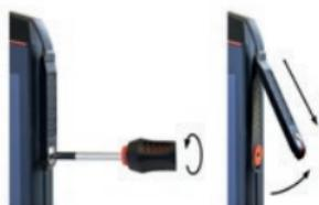
» Za pomocą wkrętaka z zestawu zatwierdzonego przez firmę i.safe odkręć wkręt pokrywy interfejsu 8-pin ISM. Zdejmij pokrywę w przedstawiony sposób.
