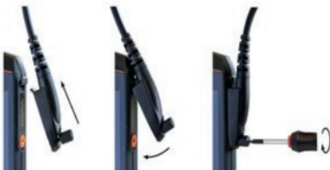
» Sluit de stekker van het accessoire aan op de 8-pin ISM-aansluiting zoals is getoond.
