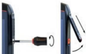
» Løsne skruen i dekselet for 8-pin ISM-grensesnittet med skrutrekkeren som fulgte med det godkjente tilbehøret. Fjern dekselet som vist.
