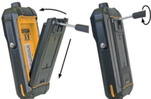
» Coloque la batería en el compartimento de la batería tal y como se muestra. Asegúrese de que los contactos de color dorado de la batería y el dispositivo estén uno frente a otro.
