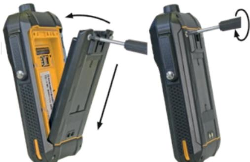
» Helyezze az akkumulátort az akkumulátortartóba az ábra szerint. Ügyeljen rá, hogy az akkumulátor és a készülék aranyszínű érintkezői egymás felé nézzenek.
