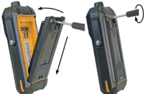
» バッテリーは図のようにバッテリーソケットに取り付けます。バッテリーとデバイスの金色の接点が向かい合っていることを確認してください。
