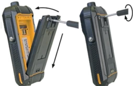
» Placera batteriet i batteriutrymmet enligt bild. Se till att de guldfärgade kontakerna på batteriet och enheten är vända mot varandra.
