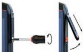
» 承認されたアクセサリパッケージに入っているドライバーで、8-pin ISMインターフェースカバーのネジを緩めます。図のようにカバーを取り外します。
