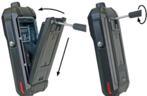
» バッテリーは図のようにバッテリーソケットに取り付けます。バッテリーとデバイスの金色の接点が向かい合っていることを確認してください。
