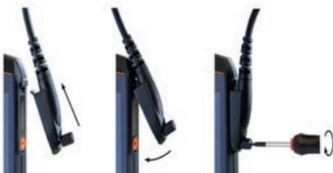
» W pokazany sposób podłączyć wtyczkę zatwierdzonego akcesorium do interfejsu 8-pin ISM.
