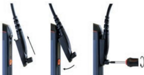
» Conecte o plugue do acessório aprovado à interface 8-pin ISM, conforme exibido.
