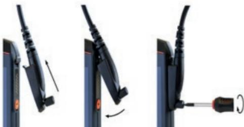
» Verbinden Sie den Stecker des freigegebenen Zubehörs wie abgebildet mit der 8-pin ISM-Schnittstelle.
