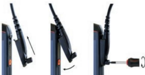
» Liitä hyväksytyn lisälaitteen liitin laitteen 8-pin ISM-liitintään kuvan mukaisesti.
