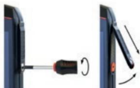
» Uvoľnite skrutku na kryte rozhrania 8-pin ISM pomocou skrutkovača, ktorý je súčasťou schváleného balenia príslušenstva. Odstráňte kryt, ako je znázornené na obrázku.
