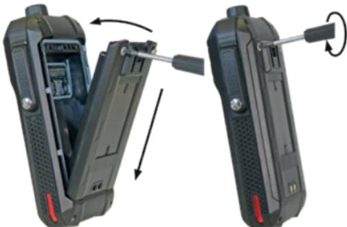
» Insérez la batterie dans le compartiment de la batterie en procédant de la manière représentée. Veillez à ce que les contacts dorés de la batterie et ceux de l'appareil pointent bien les uns vers les autres.
