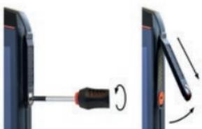
» Desserrez la vis du couvercle de l'interface 8-pin ISM à l'aide du tournevis inclus dans l'emballage des accessoires agréés. Retirez le couvercle comme indiqué.
