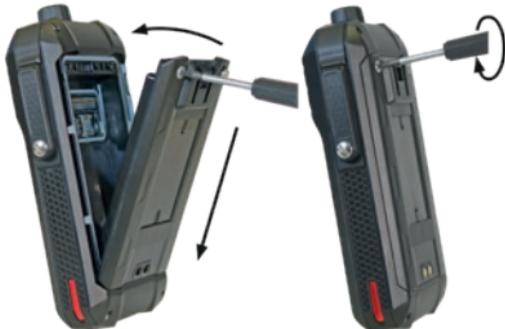
» 如图所示, 将电池放入电池仓中。请确保电池的金色触点与设备的触点对齐。
