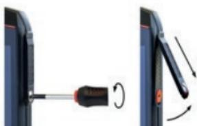
» Povolte šroub na krytu rozhraní 8-pin ISM pomocí šroubováku, který je součástí schváleného balení příslušenství. Podle obrázku odstraňte kryt.
