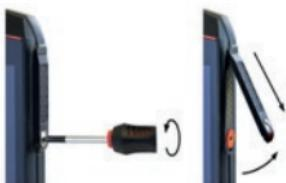
» Løsn skruen på 8-pin ISM-grænsefladens dæksel med skruetrækkeren fra den godkendte tilbehørspakke. Tag dækslet af som vist.
